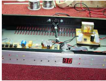
Caja de Control en Proceso de armado.
